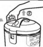
2. Раскрутите его справа налево на две части. Вымойте и протрите его сухой тканью.
